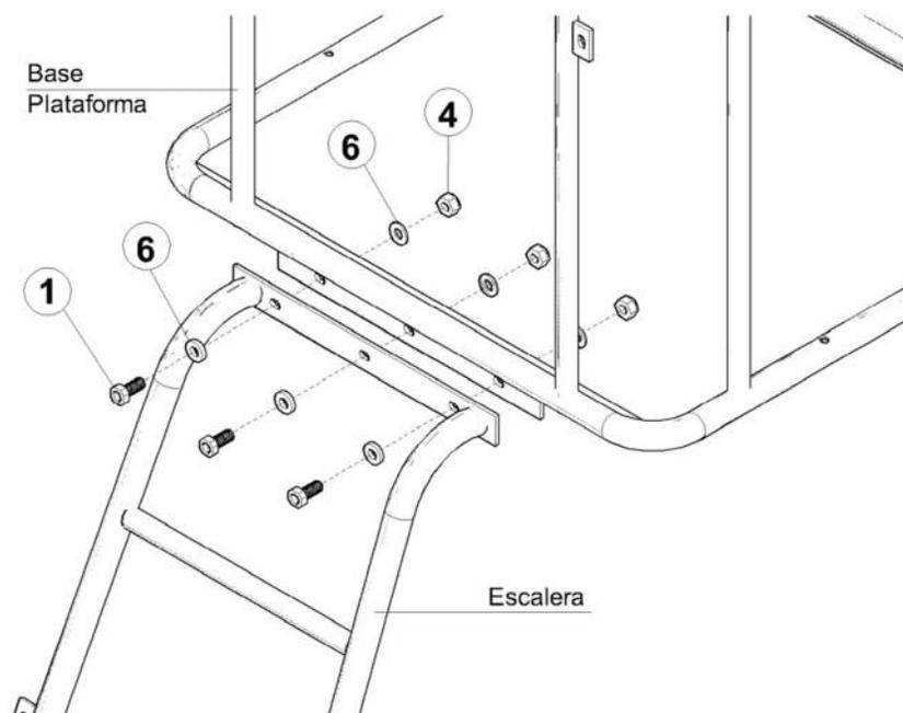
Con la base y las escalas armadas ahora instale el travesaño, haga coincidir las perforaciones de ambos extremos con las placas instaladas en el segundo peldaño de las escalas, este proporcionará rigidez a la estructura base, apriete los pernos:
