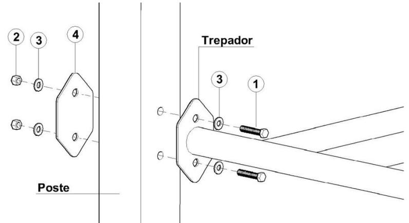
Luego instale la pisadera (E) en las perforaciones inferiores de los postes (A y B) según imagen:
